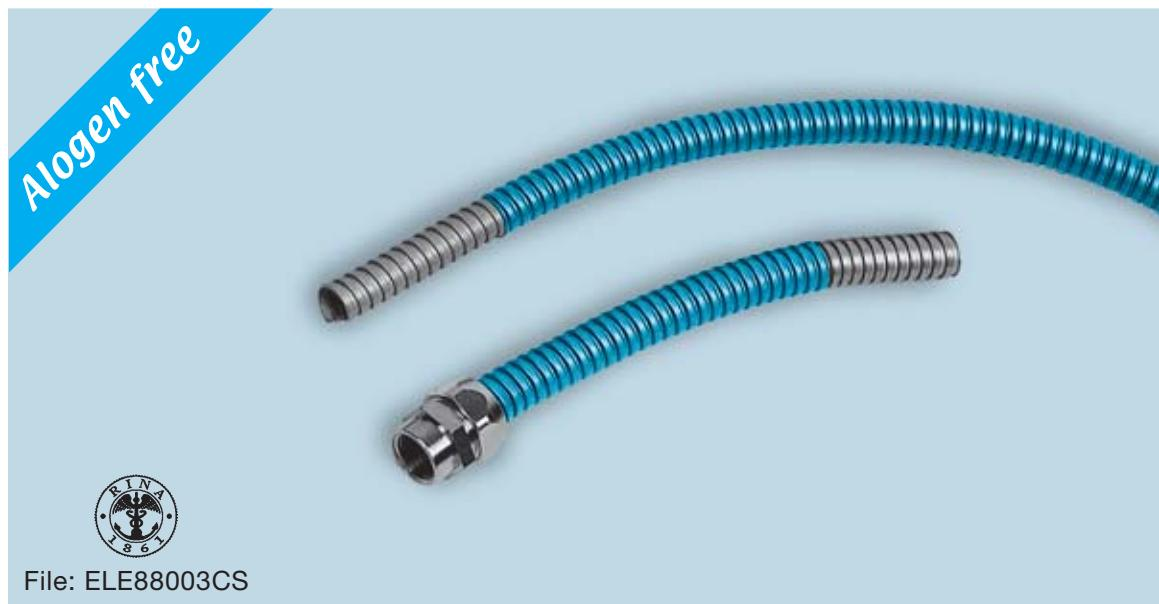
Ευλύγιστος σωλήνας από ψευδαργυρωμένο Χάλυβα με εσωτερικό μεταλλικό σφιγκτήρα και καλυμμένος από γαλάζια ΠΟΛΥΟΥΡΕΘΑΝΗ χωρίς αλογόνα ελαφρού πάχους κολλημένη εν κενώ στο μεταλλικό στέλεχος.
