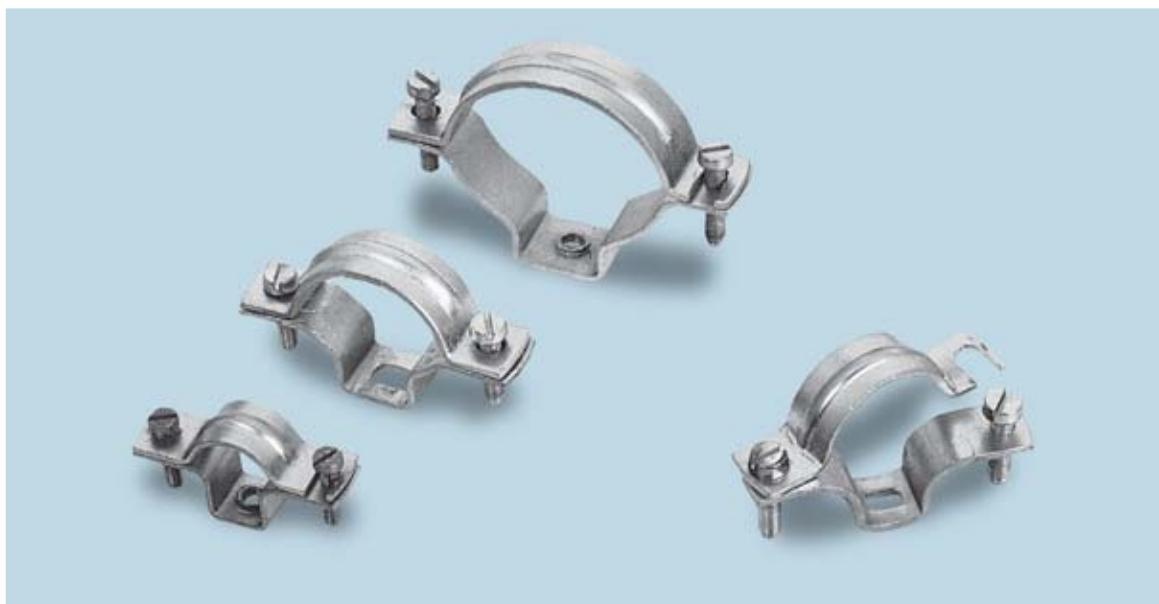
Τα κολάρα TZR είναι κατασκευασμένα από ψευδαργυρωμένο χάλυβα και χρησιμοποιούνται για την στερέωση των σωλήνων τόσο μεταλλικών όσο και από PVC στον τοίχο.
