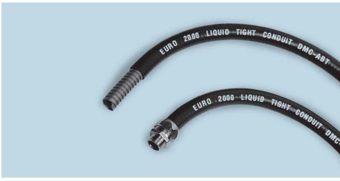
Ευλύγιστος σωλήνας από **ψευδαργυρωμένο Χάλυβα** με μεταλλικό σφιγκτήρα και καλυμμένος από **PVC μάυρου** χρώματος μεγάλου πάχους με καλή πρόσφυση στο μεταλλικό στέλεχος και ανθεκτικό στις υψηλές και χαμηλές θερμοκρασίες με ένα **εύρος χρήσεως από -40° έως +105° κατά διαλείμματα έως +120°**.
