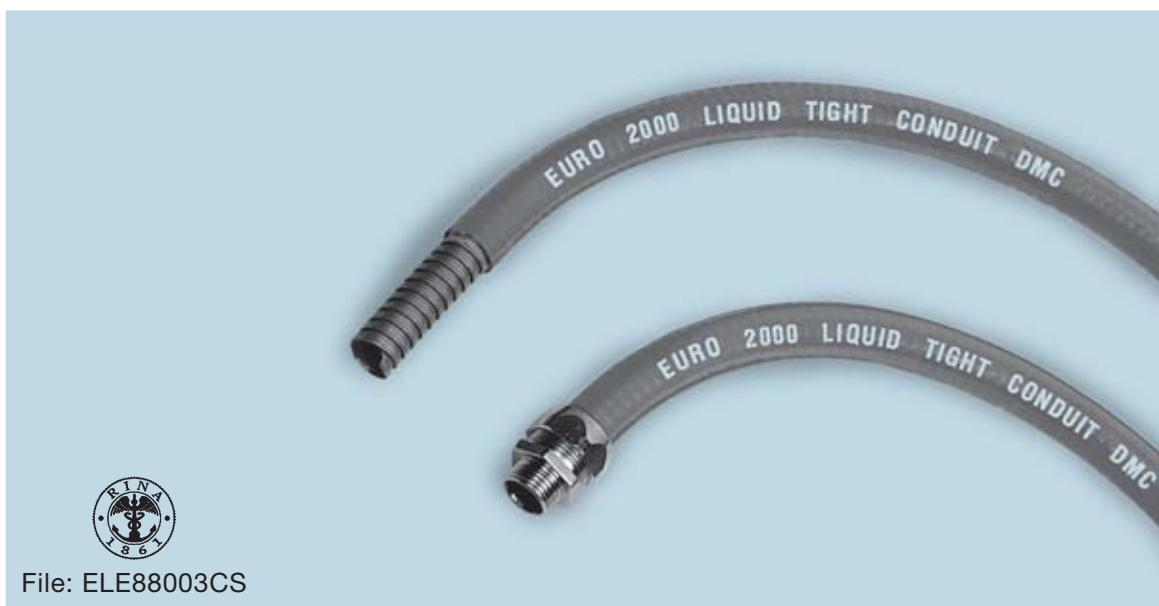
Ευλύγιστος σωλήνας από **ψευδαργυρωμένο Χάλυβα** με μεταλλικό σφιγκτήρα και καλυμμένος από **PVC γκρι** χρώματος μεγάλου πάχους και με καλή πρόσφυση στο μεταλλικό στέλεχος.
