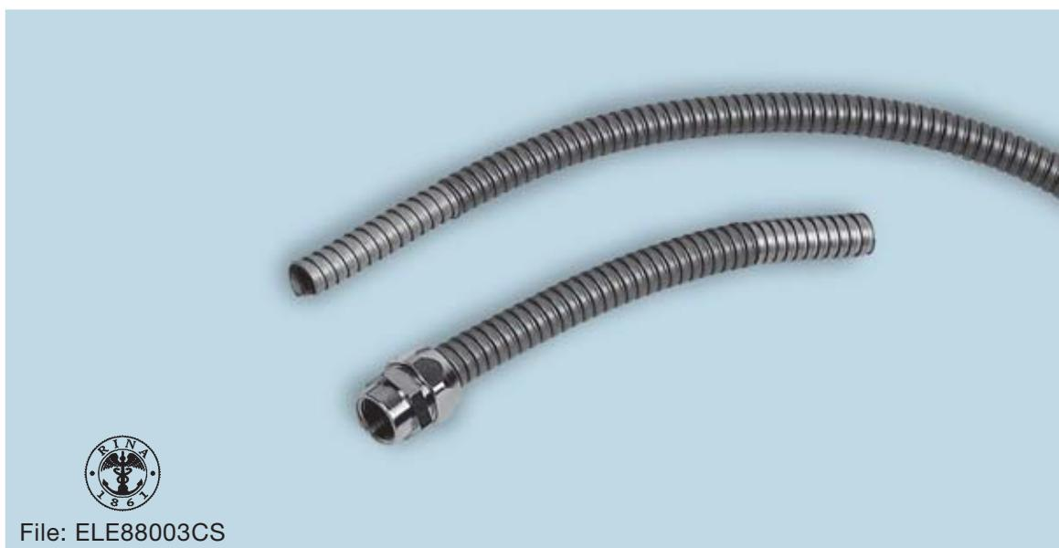
Ευλύγιστος σωλήνας από **ψευδαργυρωμένο Χάλυβα** με εσωτερικό μεταλλικό σφιγκτήρα και καλυμμένο από **PVC γκρι** χρώματος ελαφρού πάχους κολλημένο εν κενώ επάνω στο μεταλλικό στέλεχος. Ενδείκνυται ιδιαίτερα όπου απαιτείται καλή μηχανική αντοχή και άριστη αντοχή στην έλξη, στην στρέψη και στην συμπίεση. Αυτοσβενόμενο, έχει υψηλή αντοχή στο πέρασμα του χρόνου, στα έλαια και στα οξέα που χρησιμοποιούνται γενικά στις βιομηχανίες.
